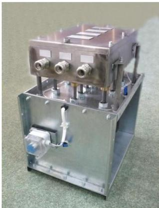
Взрывозащищенные канальные нагреватели воздуха ФЭКВ2 применяются в системах при низких давлениях (до 0,02 бар) с принудительной вентиляцией нагреваемого воздуха, при скорости среды в канале около от 2 м/с и более.
