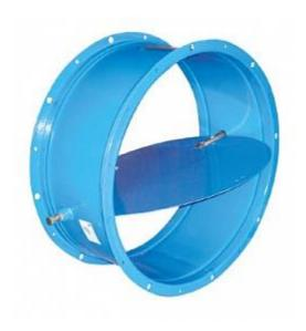
Самооткрывающиеся клапаны **A3E 034.000** предназначены для предотвращения утечек теплого воздуха из помещения при неработающем вентиляторе. Они могут применяться только при использовании вентилятора без сети воздуховодов.
