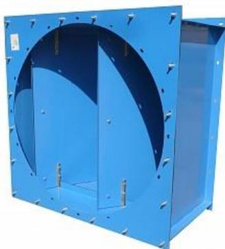
Клапаны лепестковые стальные **КЛ.00.000** предназначены для установки на нагнетательной стороне осевых вентиляторов типа 06-300 №№ 4-12.5 с целью предотвращения попадания холодного воздуха и атмосферных осадков в производственные помещения после отключения вентиляторов.
