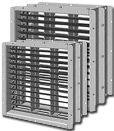
Устройства перекрытия вентиляционных каналов (УПВК) Предназначены для защиты вентиляционных проемов сооружений АЭС, при установке их в строительных конструкциях и в воздуховодах вентиляционных систем, от воздушной ударной волны детонационного взрыва. Устройства перекрытия вентиляционных каналов (УПВК) обеспечивают функцию безопасности, сохраняют прочность и работоспособность:
