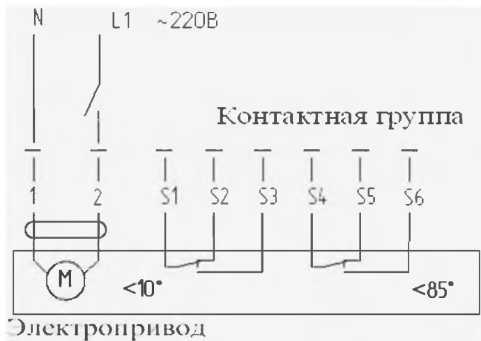
схема подключения электромеханического привода «ALLFA»(220)
